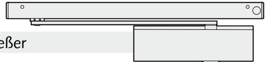
Türschließer bewirken das sichere und selbsttätige Schließen einer Tür und sind geeignet für 1-flügelige Anschlagtüren bis zu einer max. Flügelbreite von 1.100mm. Die Türschließer verfügen über eine stufenlos einstellbare Feststellung von 80° bis 130° und einer stufenlos einstellbaren Schließkraft nach DIN EN 1154.
