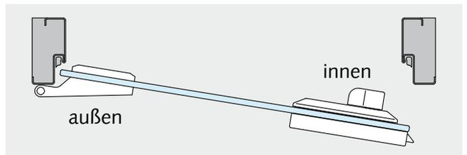
Bedienknebel auf Klemmplattemseite (DIN links auswärts)
