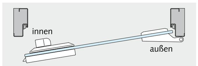
Bedienknebel auf Klemmplattemseite (DIN rechts auswärts)
