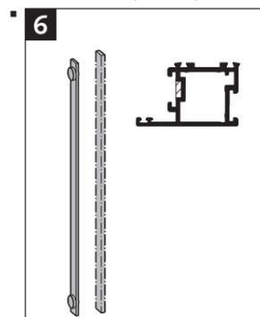
Bei Einsatz der Verbindungsstange **6** in Verbindung mit einer vertieften Flügelnut, ist bauseits ein Futterstück vorzusehen.
