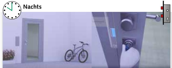
Die Tür kann, z. B. nachts, abgeschlossen werden, wodurch sie durch Falle und Riegel zugehalten wird.
