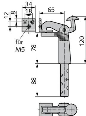
**Torfeststeller mit Steindolle zum Einmauern**
