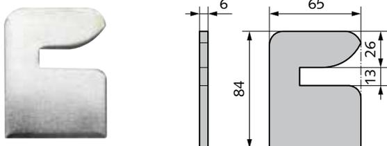
Keilstück für Hebelverschlüsse
