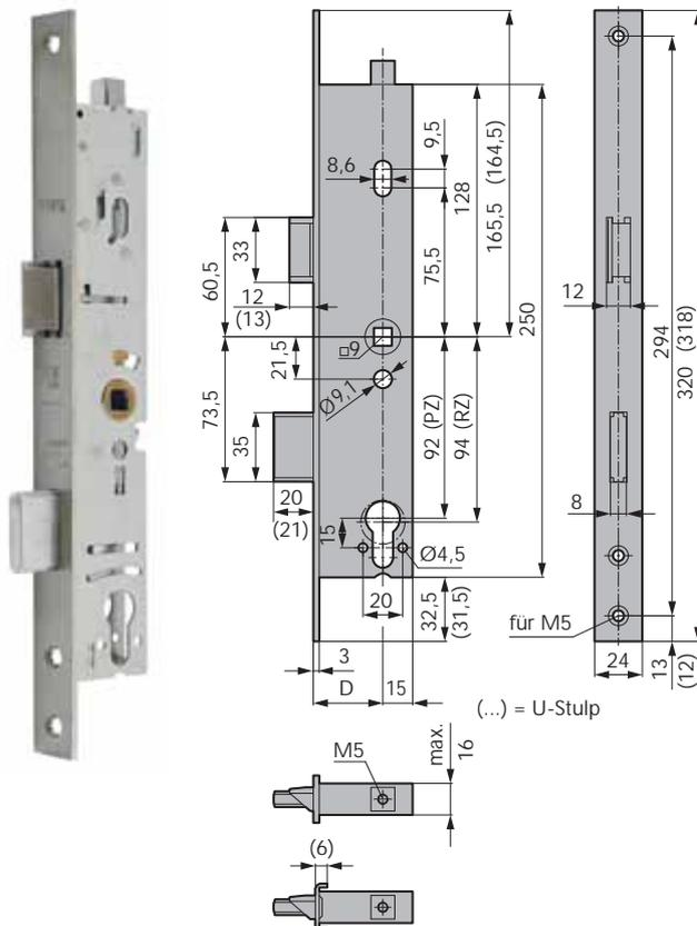
Einsteckschloss mit Zusatzverriegelung
