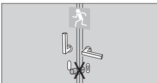
In Panikschlössern dürfen elektronische Knaufzylinder eingesetzt werden wenn sie leichtgängig sind.
