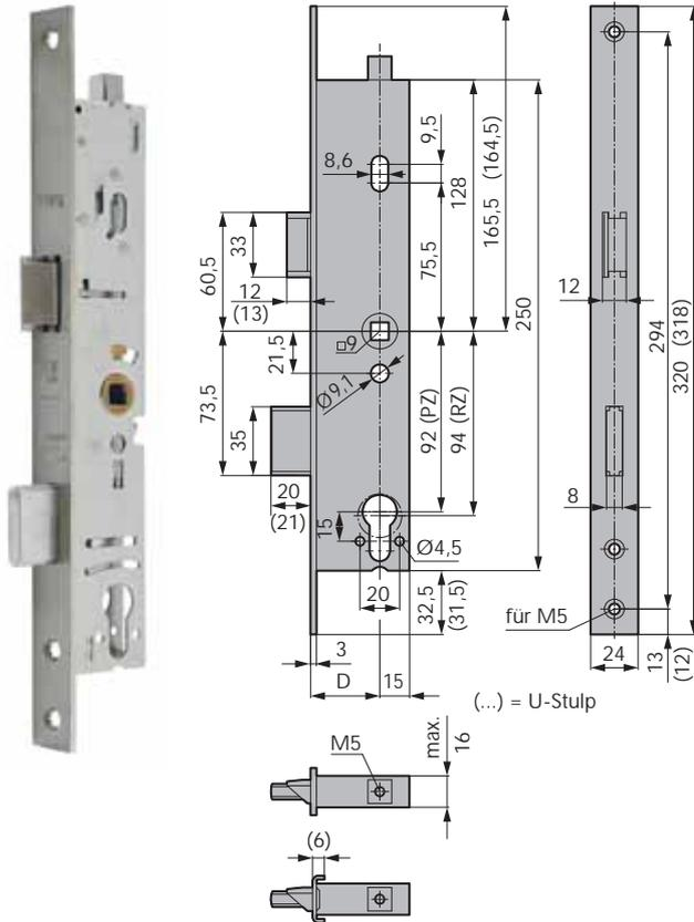
Einsteckschloss mit Zusatzverriegelung
