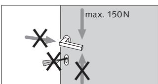
Der Drücker darf nur im normalen Drehsinn belastet werden. In Betätigungsrichtung darf auf den Drücker maximal nur eine Kraft von 150N aufgebracht werden.
