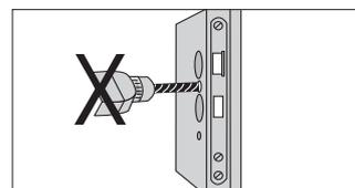
Das Türblatt darf im Schlossbereich nicht bei eingebautem Schloss durchbohrt werden.
